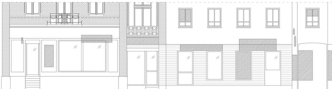
1 KROK: USUNIĘCIE NADMIARU REKLAM Z ELEWACJI
