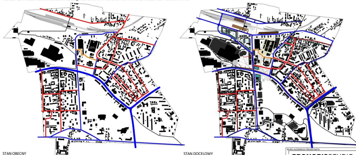
KONCEPCJA PRZESTRZENNA ŚRÓDMIEŚCIA_PROPONOWANY UKŁAD KOMUNIKACJI KOŁOWEJ - PORÓWNANIE
