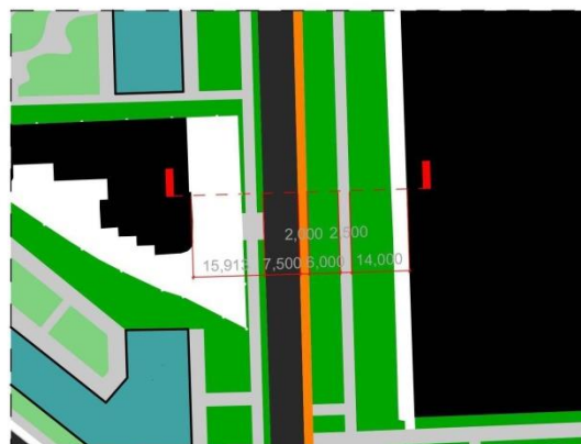
Rys. Proponowany przekrój ulicy T. Kościuszki na odcinku Królowej Jadwigi-Kolejowa (81)
