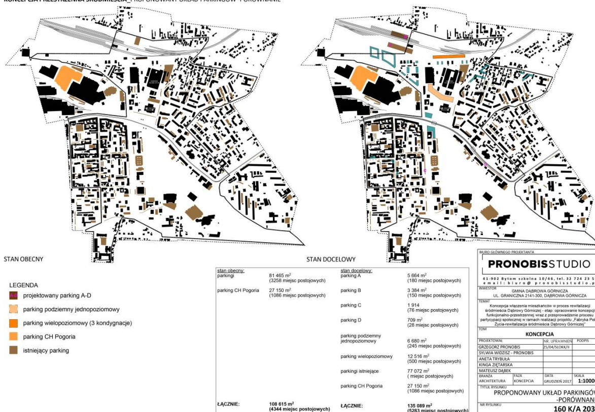
Rys. Porównanie układu dróg i lokalizacji parkingów stanu obecnego i proponowanego (85)
