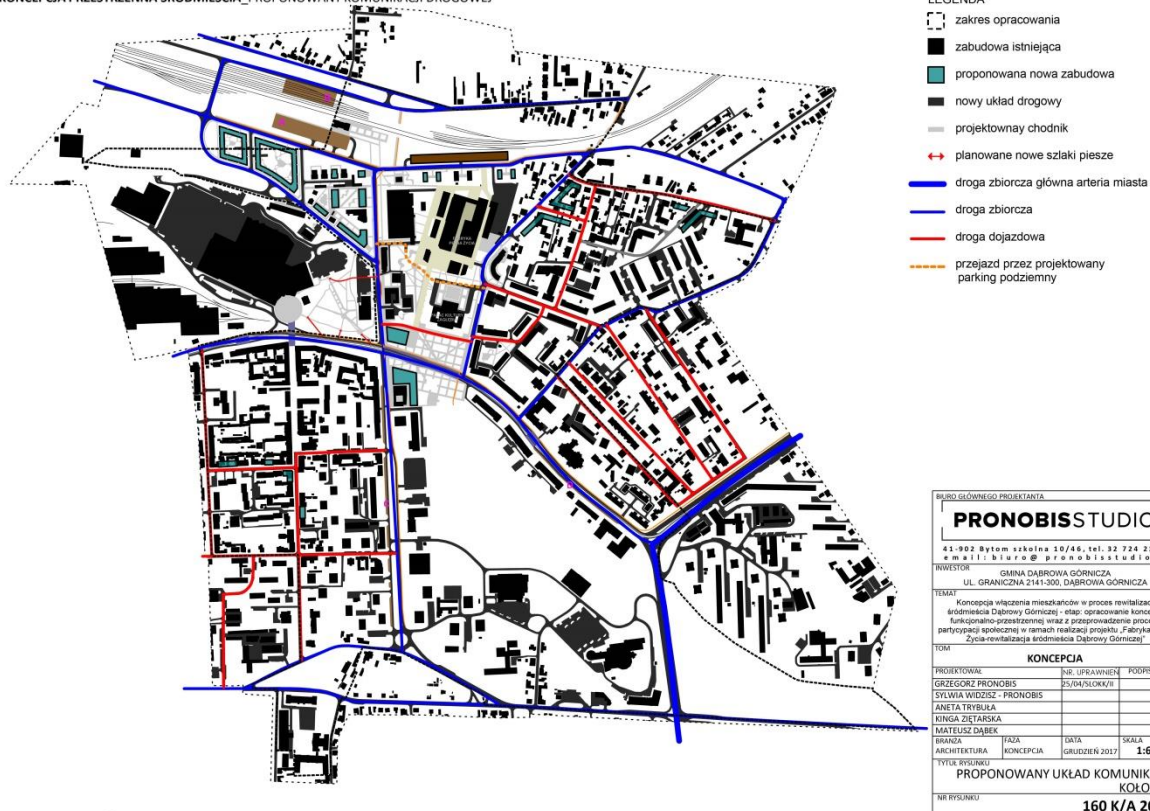
Rys. Proponowany układ komunikacji kołowej (76)
